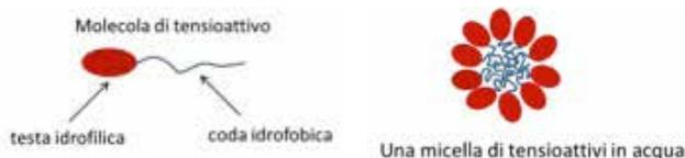
**Figura 6.** Schema di una molecola di tensioattivo (a sinistra). Disciolte in acqua, le molecole di tensioattivo si aggregano in strutture formate da molte molecole, come la micella schematizzata a destra.
